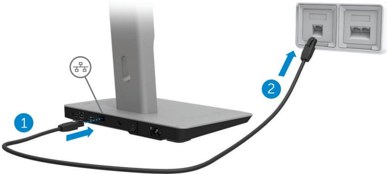
**ملاحظة:** يتم تعطيل موصل RJ-45 شبكة في جهاز الكمبيوتر عندما يتم توصيل جهاز الكمبيوتر بحامل الإرساء.
